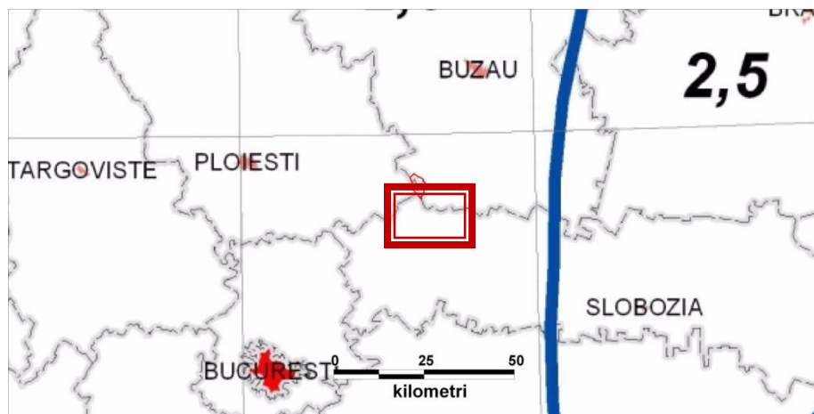
Fig. 6 Adâncimea maximă de îngheț este h = 0.70-0.80 m, conform STAS 6054/87.
